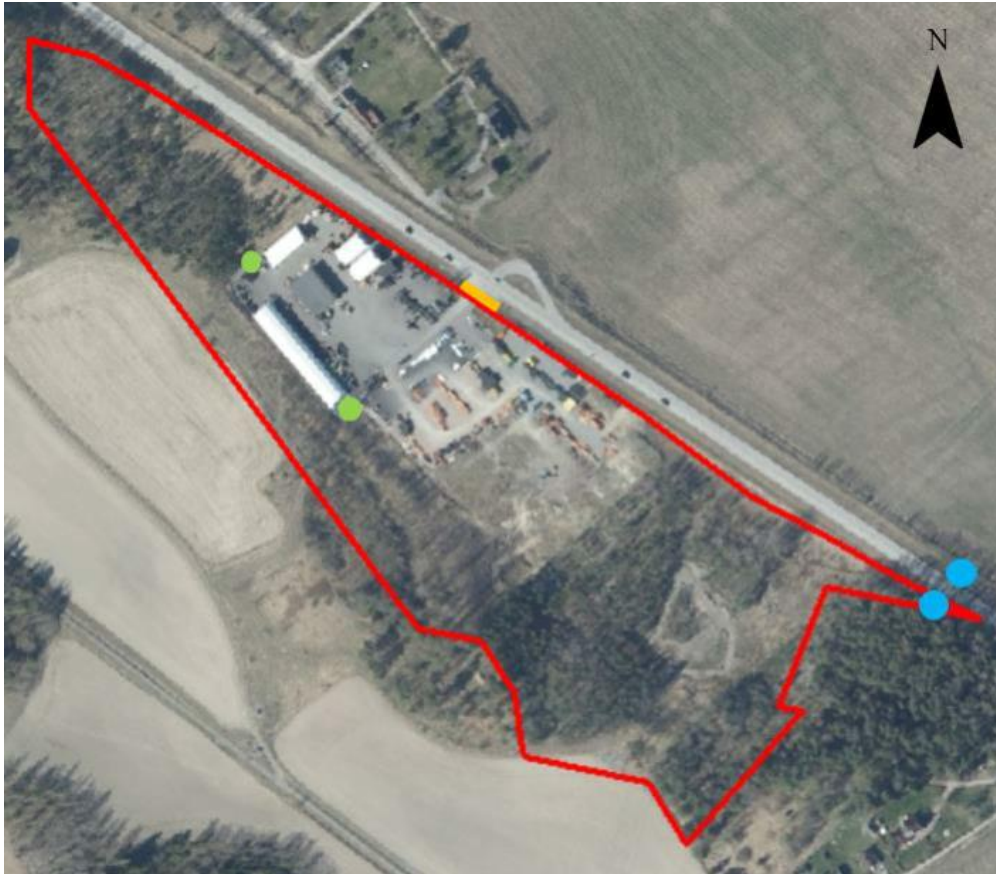
Figur 8 Grön markering visar ut eller inlopp på befintliga ledningar i området. Blå markering visar befintliga kumpulbrunnar och orange markering visar vägtrumma under infartsväg (Dagvattenutredning, Sweco 2021)
